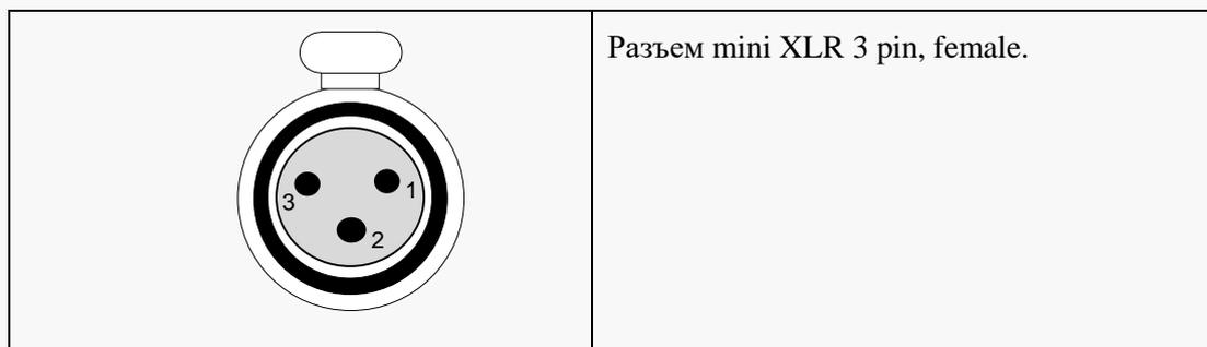
**Tally Green.....**Вход. Pin 2. Активация производится замыканием на GND (pin3).
